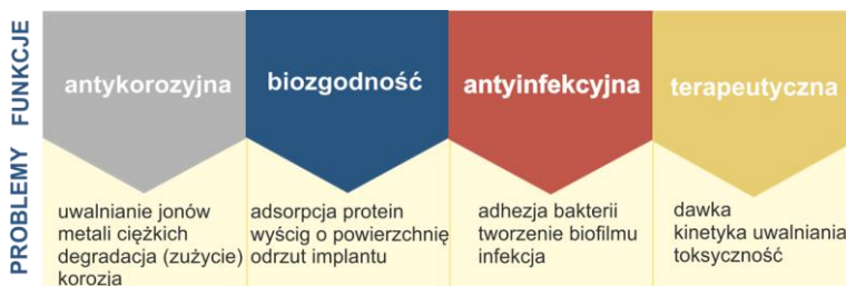
Rys. 1. Najważniejsze funkcje, które powinna spełniać nowoczesna powłoka pokrywająca implant.
